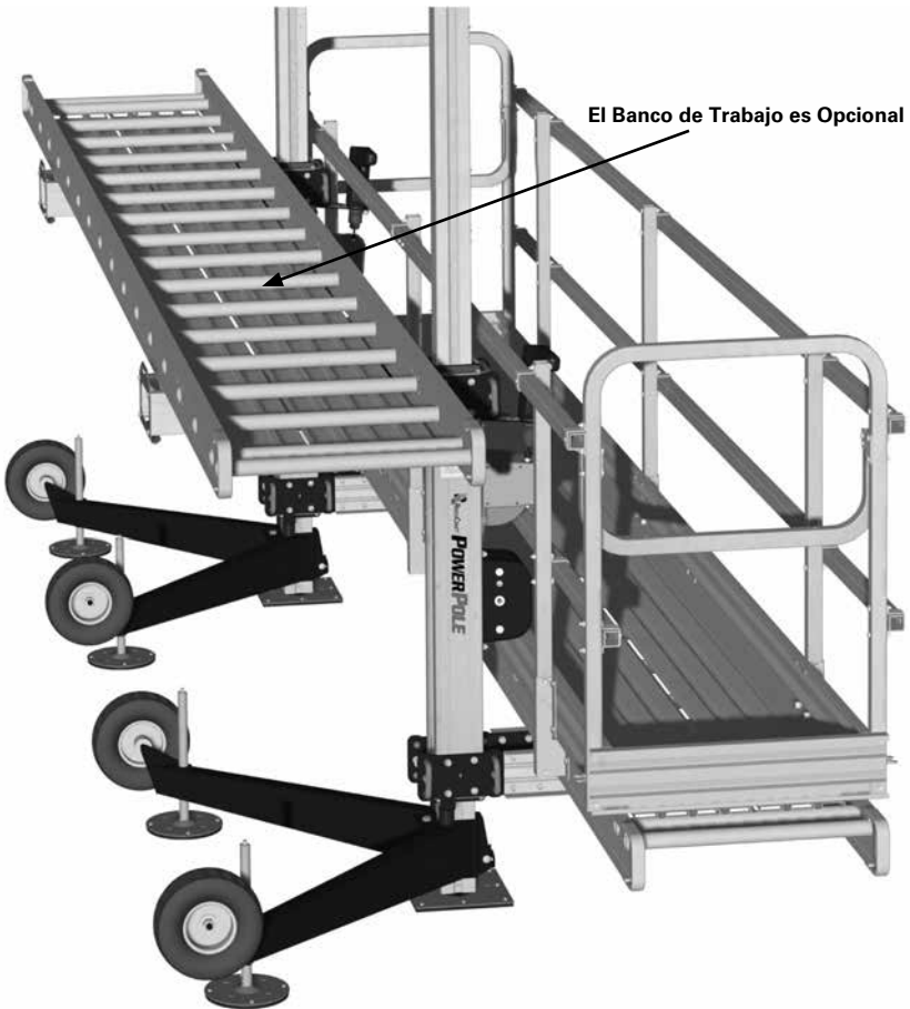
Figura 4.3 - Instalación de Banco de Trabajo
