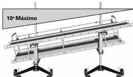
Figura 6.3 - Nivelando la Plataforma
