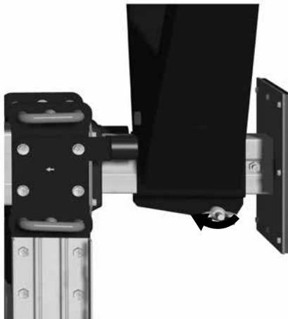
Figura 2.10 - Conectar el Balancín al Mástil
