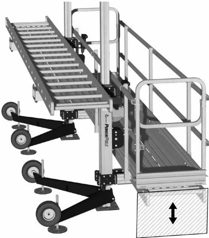
Figura 6.5 - Saliendo de la Plataforma
